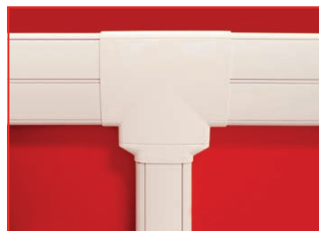
6. Установить крышки на короба Переходник соединяется с накладкой тройника и защелкивается на отводимый кабель-канал (меньшего сечения).
